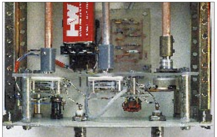
Bild 4: Rückansicht der Meßbrücke mit den Buchsen für das Meßobjekt und den Empfänger
