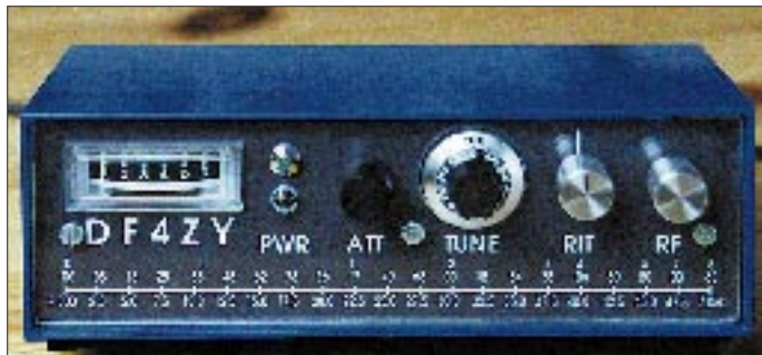
Bild 6: Betriebsbereiter CW-Transceiver für das 40-m-Band mit 2 W Ausgangs- leistung an 50 \Omega
