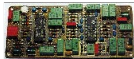
Die Kreationen von HFB-Elektronik stellen immer etwas Besonderes dar. Dieses schmale NF-Filter ist auf einer vergoldeten Platine aufgebaut und sieht super aus.
