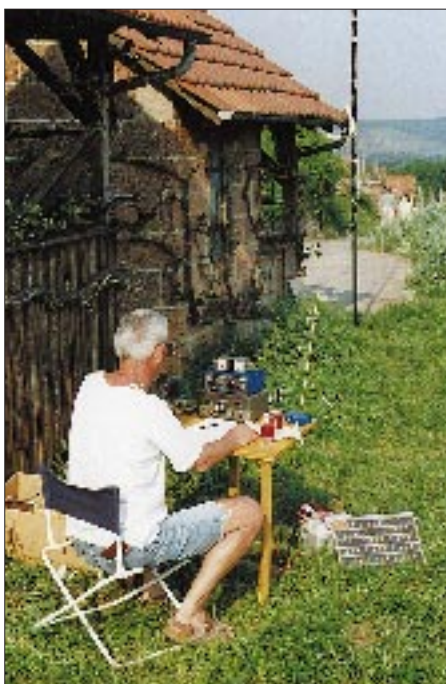
Bild 11: Portabeinsatz mit QRP-Station (HW-9 mit 5 W, Matchbox Solarpanel, Doublet, und Fiberglasmast von DK9SQ) in einem Weinberg bei Maulbronn/BW
