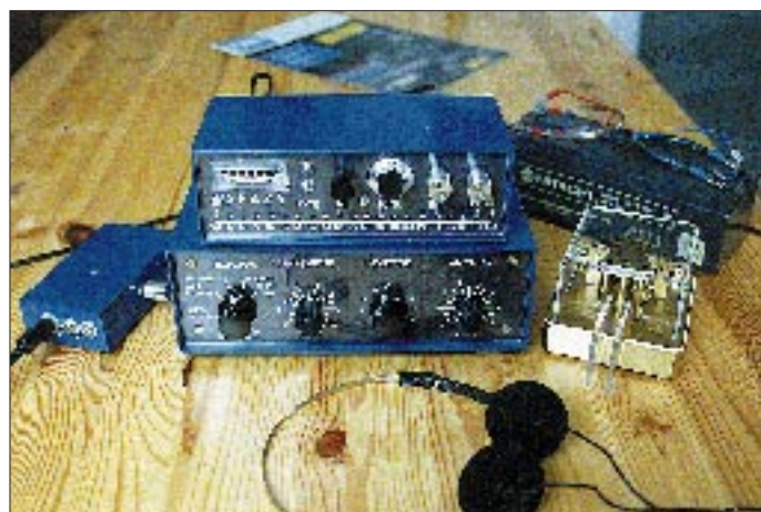
Bild 10: Komplette CW- QRP-Station für das 40-m-Band mit Stromversorgung in Form von zwei Blei- gelakkumulatoren zu je 2 Ah und Ge- ber von Schurr
